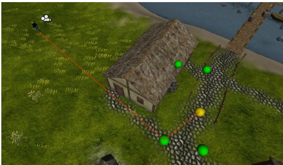
Figuur 2: Pathfinding in werking; de speler stond op de gele bol en klikte op de plek waar hij nu staat. Het berekende pad is hier rood weergegeven.
